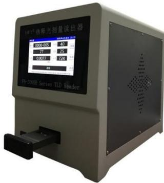
YD-2000B 型热释光剂量读出器可以对经过 X  $\gamma$ 、 $\beta$ 、中子等射线辐照后的热释光探测器进行测量，给出读出值、剂量值，具有自动校准、扣除本底、加温参数设置和打印等功能。热释光剂量读出器可连接计算机，通过热释光剂量读出器应用软件，进行数据管理、打印等。适合于从环境本底测量直至放射治疗剂量，辐射探伤照射剂量控制，核事故剂量测量监测等。
